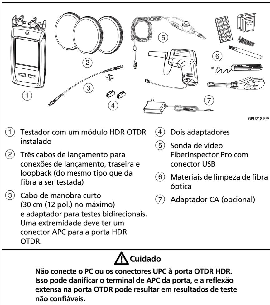
Figura 109. Equipamento para testes com o SmartLoop
