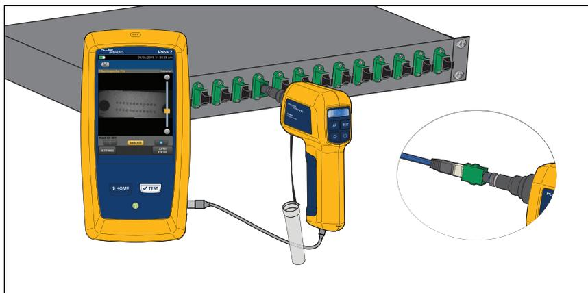
**Figura 48. Inspeção de uma extremidade (FI-3000 exibido)**
