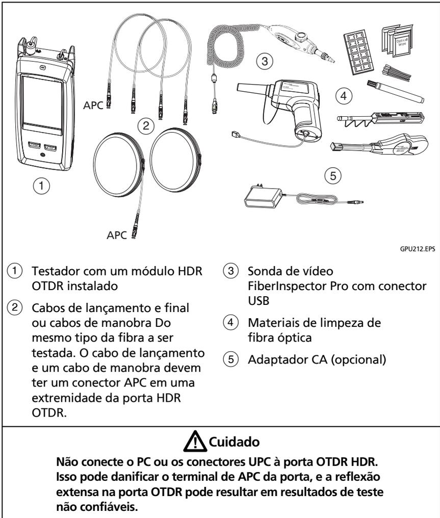
Figura 106. Equipamento para testes com o FaultMap
