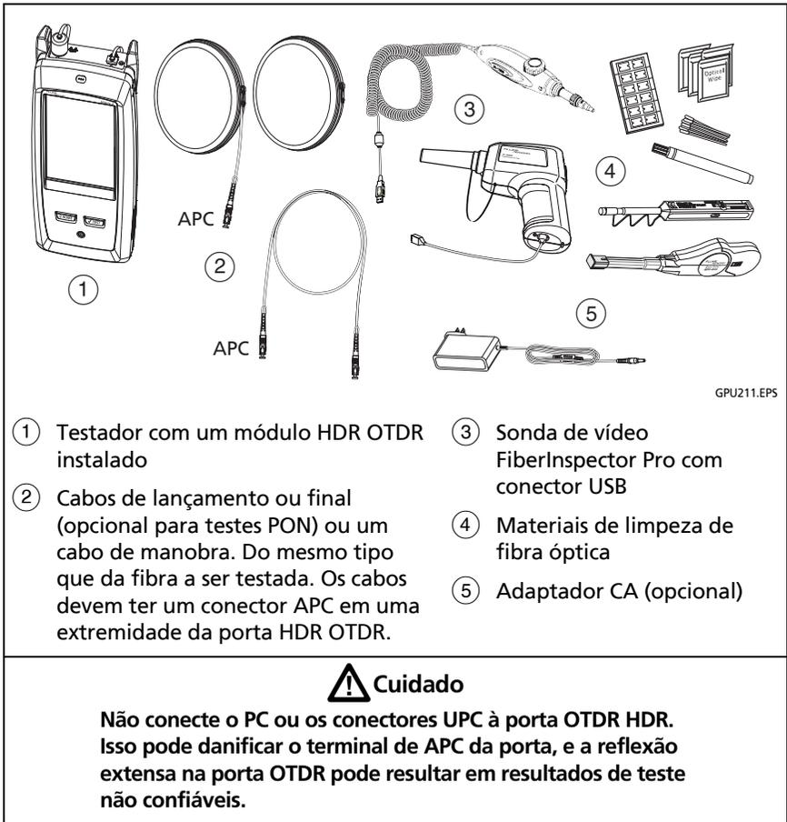
Figura 99. Equipamento para testes HDR OTDR
