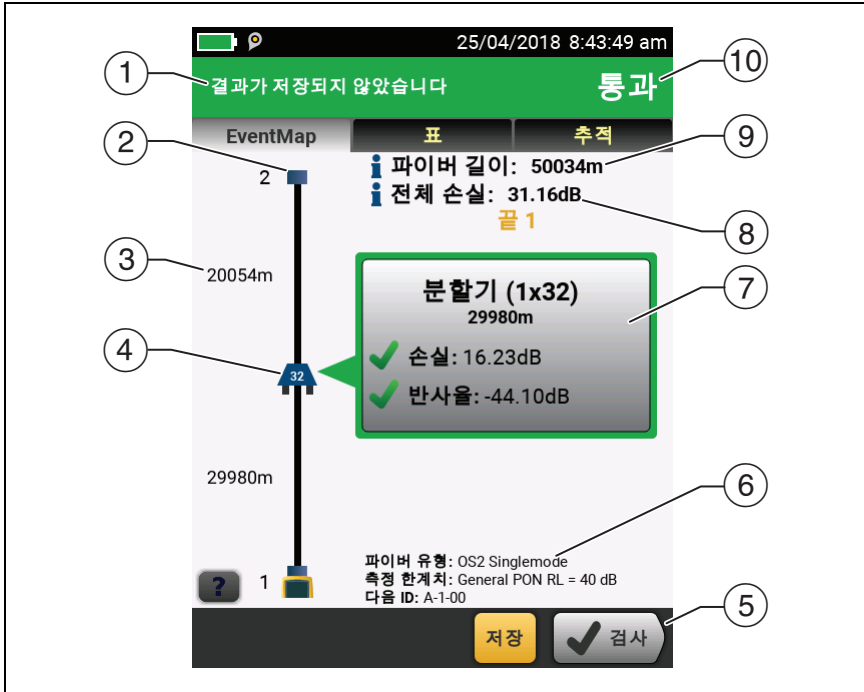
그림 102. HDR OTDR 테스트 결과에 대한 EventMap
