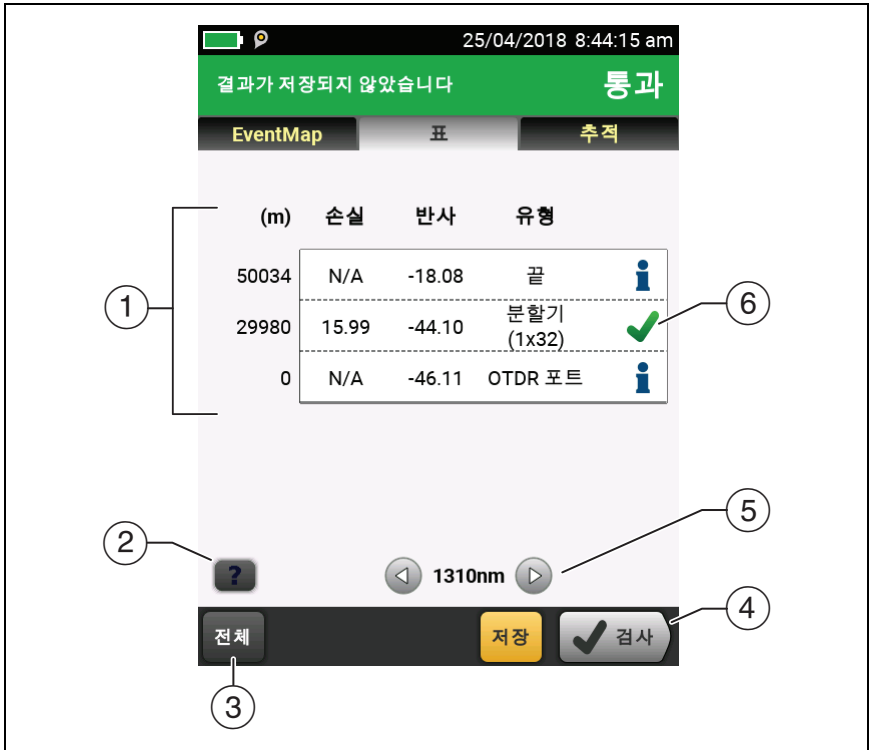
그림 103. HDR OTDR 검사 이벤트 표
