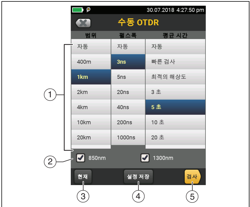
그림 85. 검사 후 빠른 변경을 위한 수동 OTDR 화면
