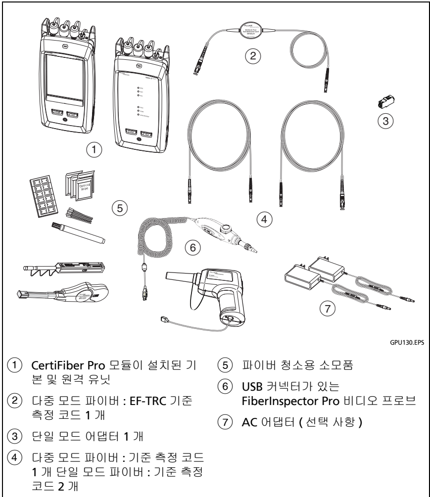
그림 66. 종단 소스 모드 자동 검사용 장비
