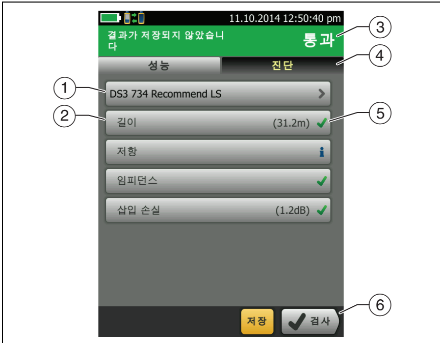
그림 31. 동축 케이블 자동 검사 결과
