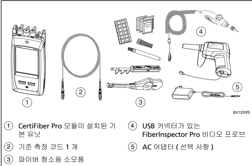
그림 121. 파워 미터 측정용 장비
