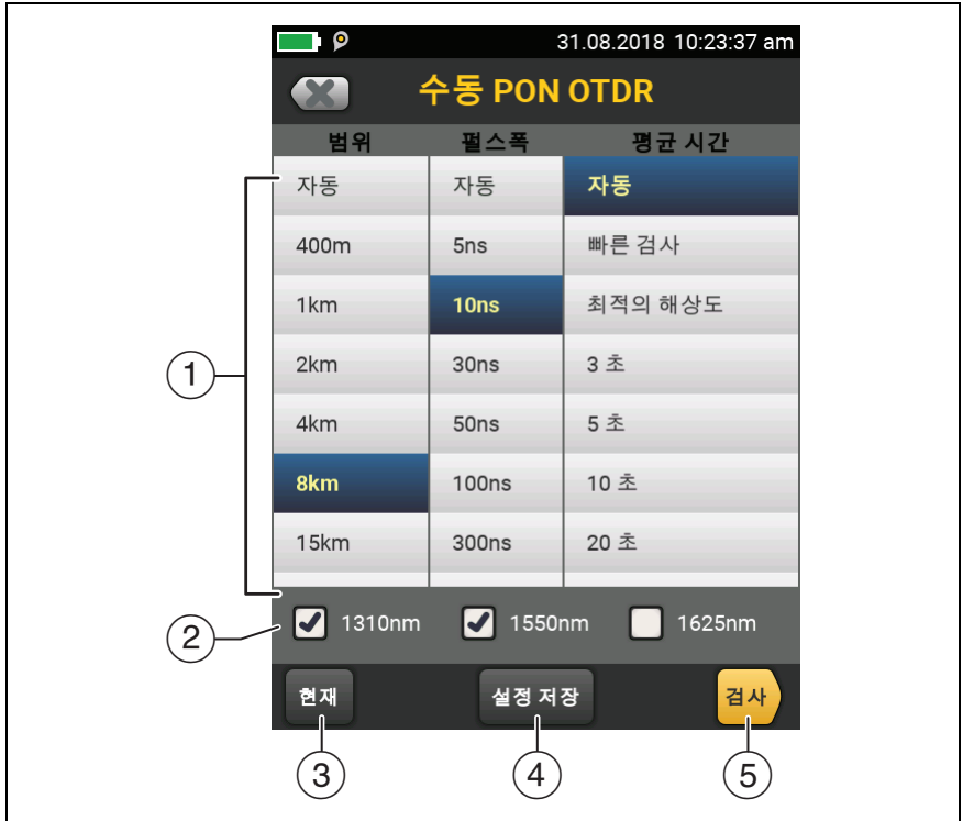
그림 105. 검사 후 빠른 변경을 위한 수동 PON OTDR 화면
