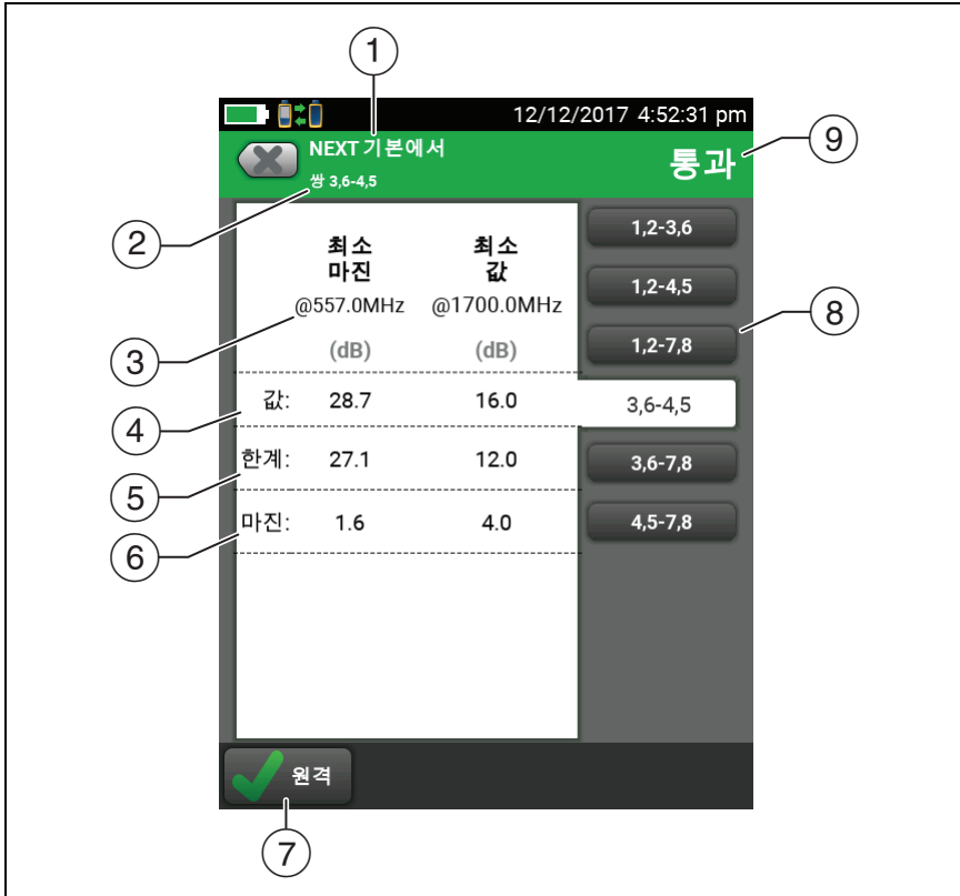
그림 26. 주파수 영역 검사에 대한 표 형식의 결과 화면
