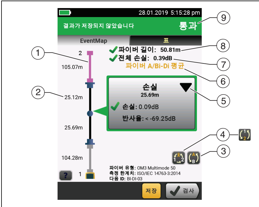
그림 94. 평균 양방향 SmartLoop 결과에 대한 EventMap
