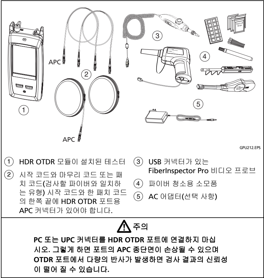
그림 106. FaultMap 검사를 위한 장비
