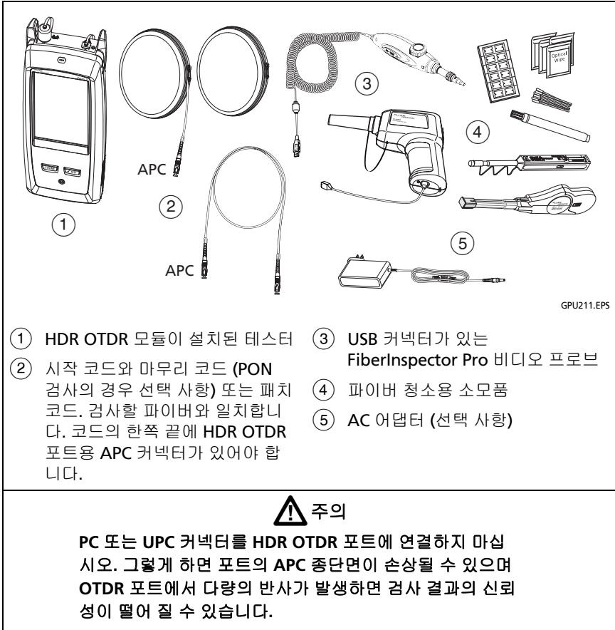
그림 99. HDR OTDR 검사를 위한 장비
