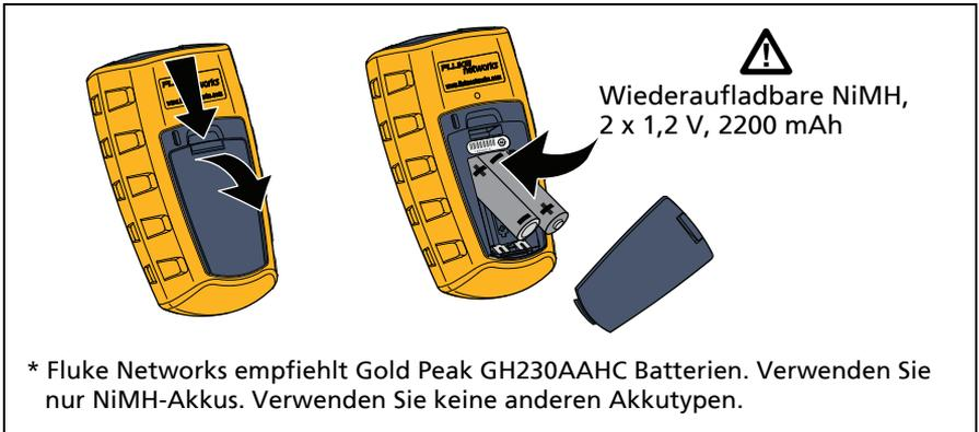
Figure 5. Die Batterien ersetzen
