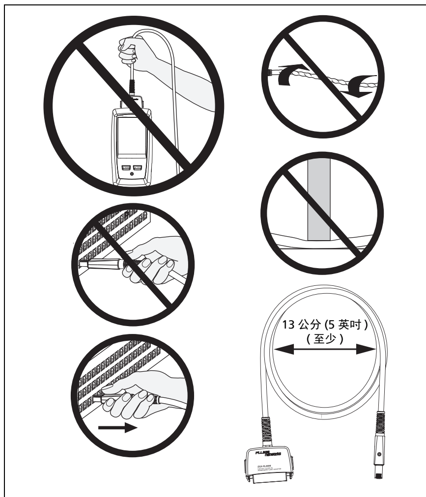
圖 4。如何避免損壞永久連結配接器電纜
