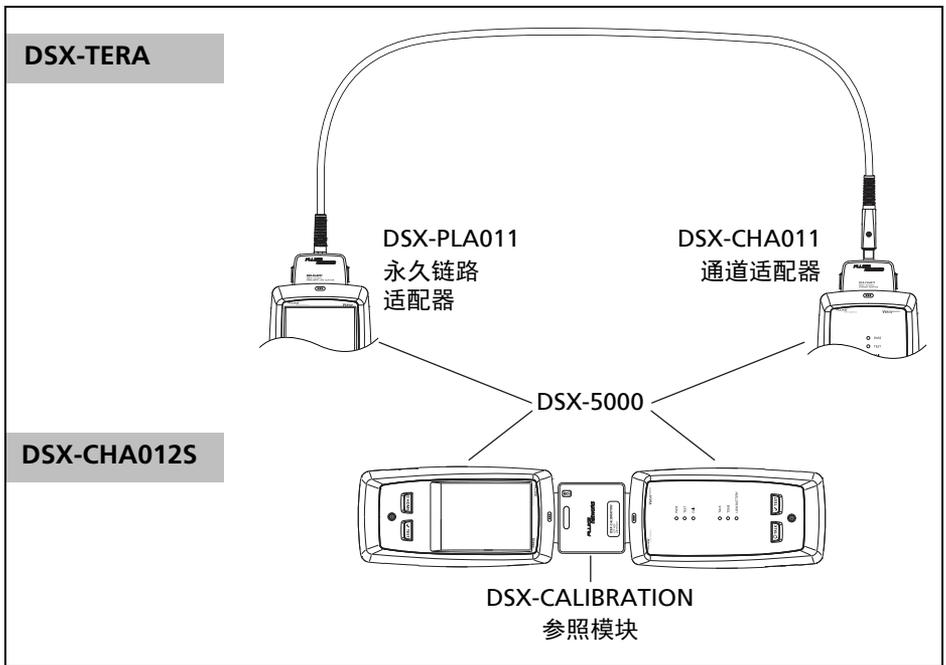
图 2. F<sub>A</sub> 类测试限制的参照连接
