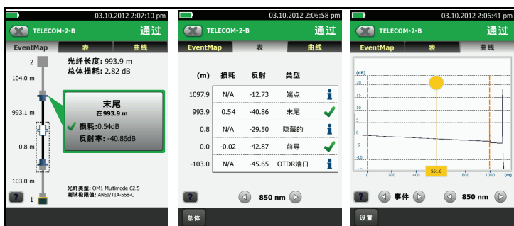
图 5. OTDR 结果屏幕示例
