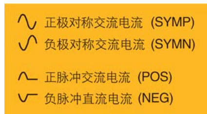
图 10. 漏电保护装置测试仪必须提供的故障电流波形。
