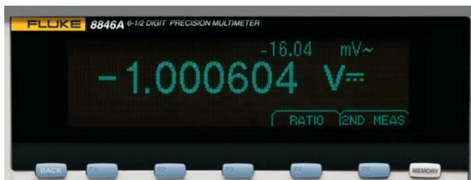
图 2. 8846A 可同时显示同一信号的不同参数
