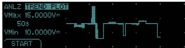
利用内置的TrendPlot 无纸记录仪以图形方式研读模拟电路中的各种漂移和突发性事件。
