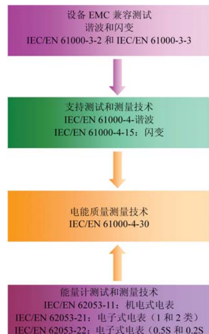
图 1. 所示为简化了的标准兼容性和参考级测量能力需求之间的关系。
