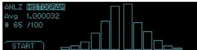
以直方图模式观察结果, 考察模拟电路中的稳定性或噪声问题。
