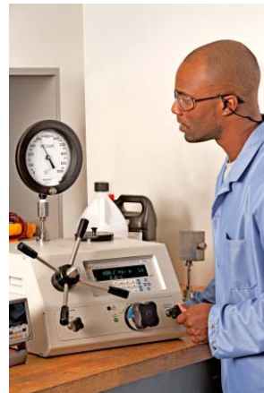
图 4. E-DWT-H 的精调阀使操作者可将压力准确设置为被测压力计的标称值
