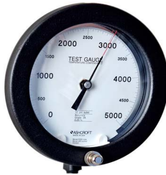
图 1. 此处所示的高压仪表(例如压力表)往往是采用液压测试介质校准的
