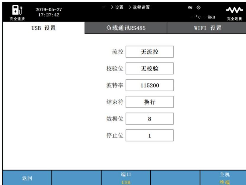
图 9. 远程设置 — USB 设置屏幕
