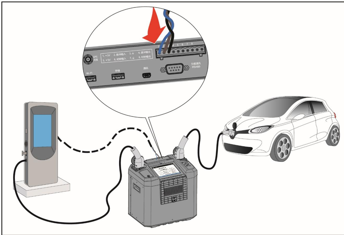
图 15. 使用实车检定示意图
