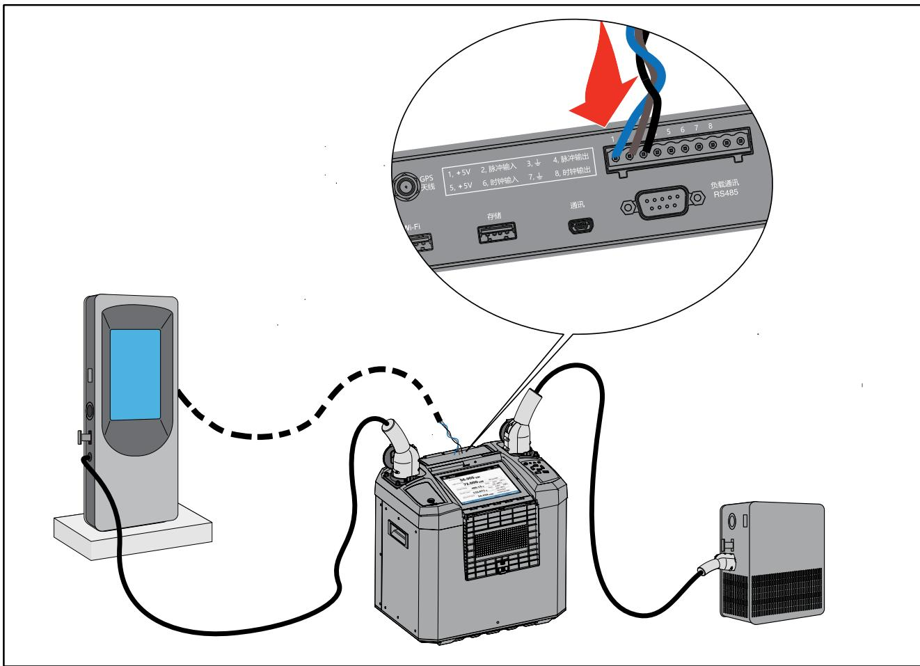
图 12. 使用负载检定连接图
