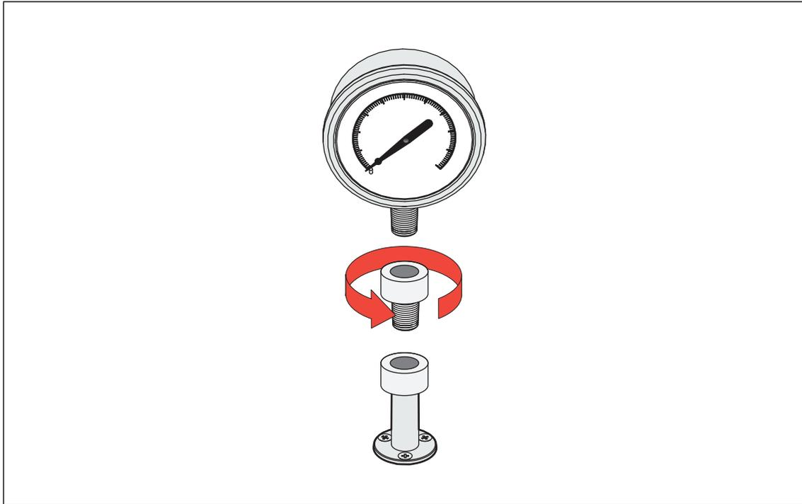
图 11. 拧固仪表适配器
