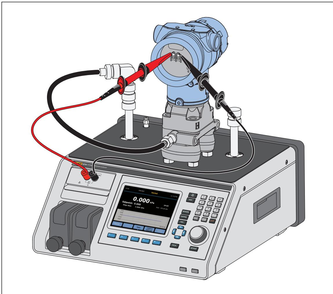
그림 16. EMM 모듈과 Test 포트를 통한 일반적인 HART 차동 트랜스미터 연결
