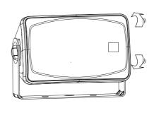
Y bracket(angle horizon -90 ° ~ 90 °, angle vertical -70 ° ~ 70 °)
