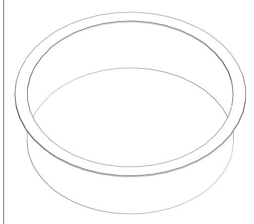
MAKE SURE GASKET MATING SURFACE IS CLEAN AND FREE FROM DEBRIS
