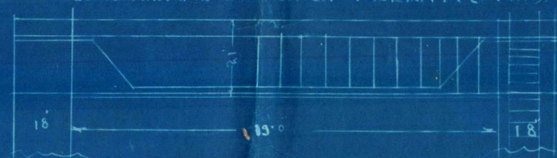
LONGITUDINAL SECTION OF T BEAM A (2'x10')
