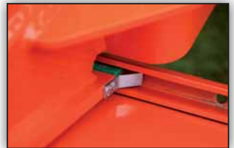
Speciale Nylon platen zorgen voor een soepele loop van de geleide rails. Smeren of onderhoud is niet nodig.
