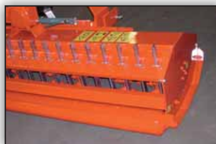
De Kubota SE3000 kan worden uitgerust met harktanden ter verbetering van het versnipperen van takken of snoeihout.
