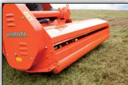
De achterste rol is standaard uitrusting, de diameter is 160mm.
