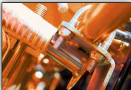
La sortie de distribution est située devant le rouleau. La position et l'angle sont réglables.
