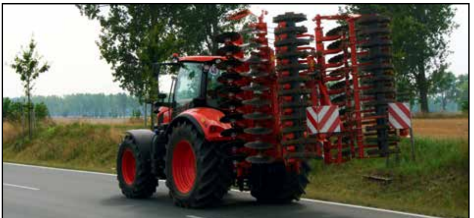
CD1000F: Largeur de transport < 2.5 m. Les déplacements sur route s'effectuent en toute sécurité.
