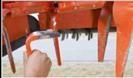
Les dents à démontage rapide sont fixées grâce à un axe et une goupille totalement intégrés dans le porte-dents.
