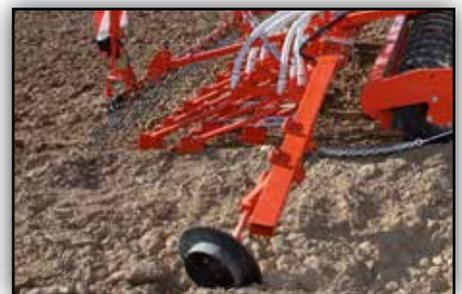
*Passer précisément d'une voie à la prochaine par l'utilisation de traceurs repliables hydrauliquement.*
