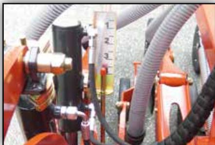
La profondeur de semis peut être ajustée sans outil par des cales d'épaisseur au niveau des deux vérins hydrauliques extérieurs.
