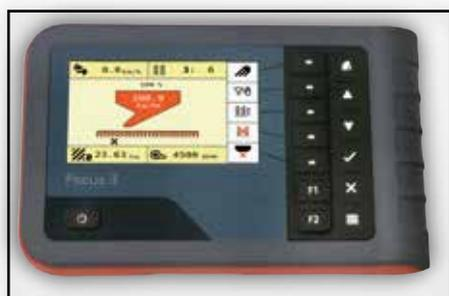
Le terminal FOCUS 3 fonctionne avec le système e-bas pour contrôler toutes les fonctions du semoir, il ne nécessite pas d'ISOBUS.
