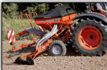
Capacité de relevage minimum grâce à une conception compacte
