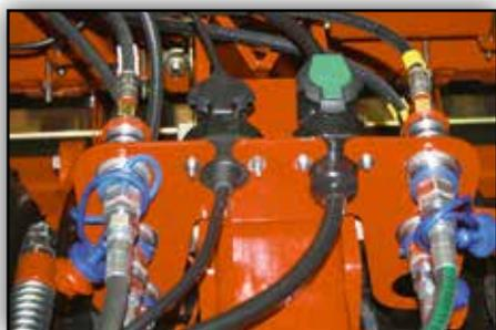
Les connexions rapides des organes hydrauliques et électriques permettent une dépose rapide des barres de semis.
