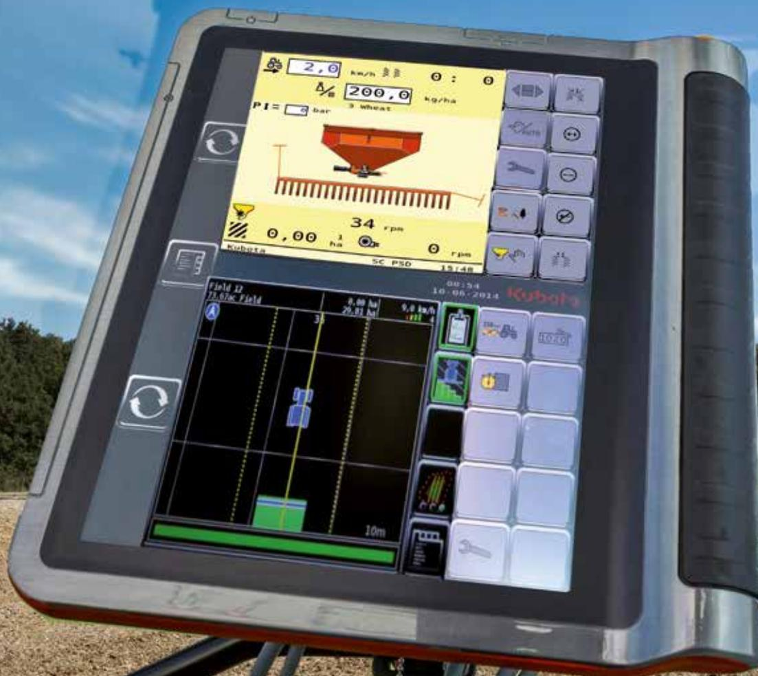
*Cela signifie que le semoir en lignes peut être connecté directement au tracteur, et être utilisé via le terminal du tracteur K-monitor, sans aucun terminal supplémentaire.*
