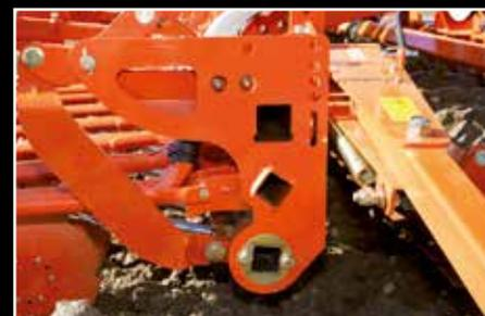
*Traceurs à repliage hydraulique vertical.*
