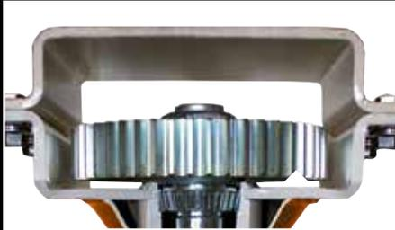
Colonne vertébrale de ces 5 modèles, le caisson est constitué de 2 demi-couvercles boulonnés de 125 X 400 mm pour la 1000, de 140 X 400 mm pour la PH2001 et de 150 X 400 mm pour la PH3000.
