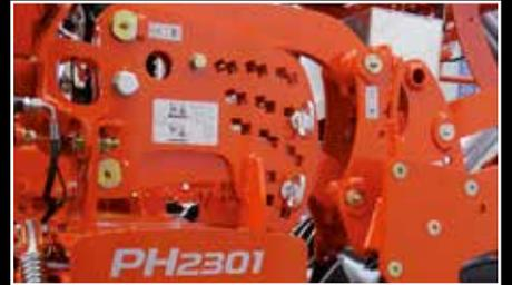
Système de réglages par parallélogramme (en standard avec SD 2001/3001 MP), permet d'ajuster la profondeur de travail par palier de 2,5 cm.
