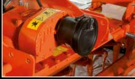
Les boîtes de vitesses à pignons interchangeables offrent de nombreuses possibilités. L'arbre d'entrée reculé facilite la liaison Tracteur-outil.
