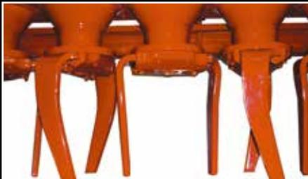
Les cônes offrent une robustesse supplémentaire au carter. Soudés sur la PH2001 et PH3000 et boulonnés sur la PH1000, ils permettent un grand dégagement entre le carter et le porte-dents.
