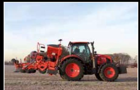
*Les éléments lourds (trémie et herse rotative) sont placés au plus proche du tracteur. Cette conception optimise la position du centre de gravité, ce qui signifie moins de besoin de puissance de relevage et assure une parfaite manœuvrabilité du tracteur. Eclairage en standard, assure un transport routier sûr à tout moment du jour et de la nuit*
