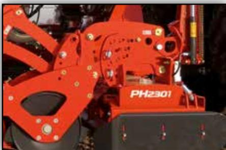
*Le parallélogramme combiné aux 4 points de fixations de la barre de semis avec le semoir garantissent un ajustement précis de la herse rotative et de la barre de semis, permettant une profondeur de semis précise.*
