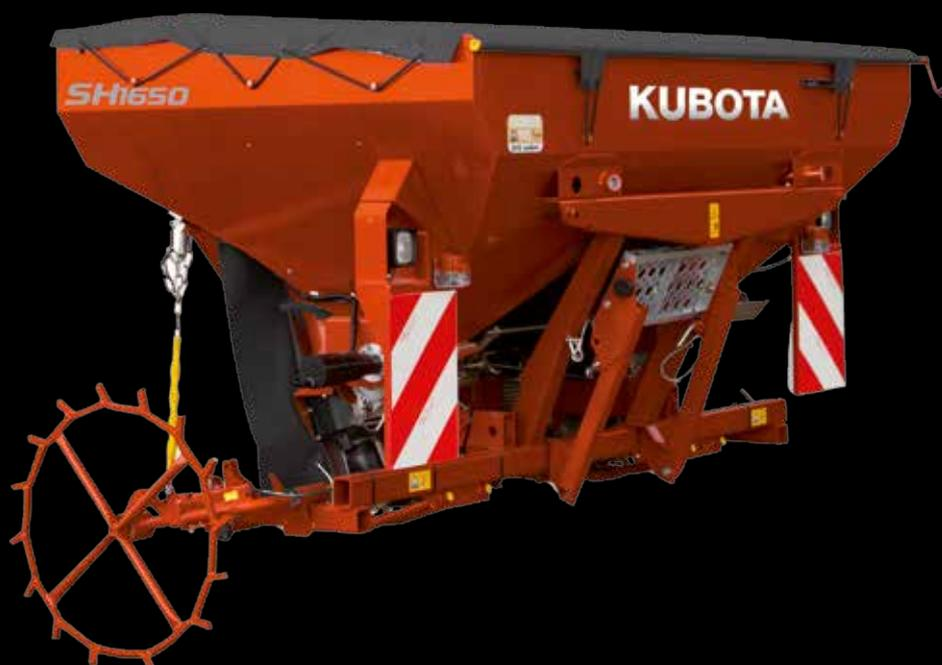
Combinée à un outil de travail du sol fixe et une barre de semis à élément semeur double-entrée (fertilisation localisée), la trémie frontale SH1650 offre un rendement de chantier élevé, un parfait équilibre de la charge et un transport sur route facile. La trémie frontale SH1650 a une conception similaire à la SH1150 avec la particularité d'être dotée de 2 doseurs afin de pouvoir alimenter une barre de semis de 4m ou un semoir de précision jusqu'à 16 rangs.
