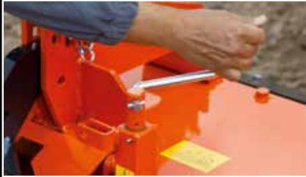
La planche niveleuse à réglage par manivelle graduée et sécurité à ressort assure un meilleur émiettement et nivellement.
