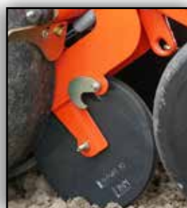
Roue plombeuse intermédiaire à bandage caoutchouc, escamotable
