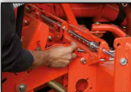
Réglage simple des écartements entre rangs par palier de 5cm
