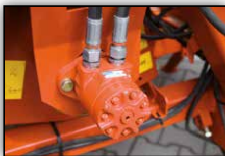
Entraînement hydraulique de la soufflerie
