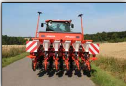
Semoir compact au transport avec une largeur <3m
