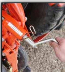
Facilité de réglage de profondeur de semis de 0 à 9cm
