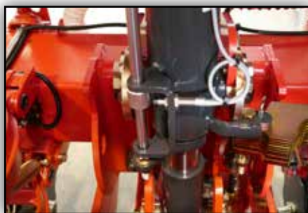
Vérin intelligent qui permet de suivre les contours du sol
