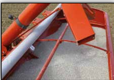
Ouverture intégrale de la trémie fertiliseur
