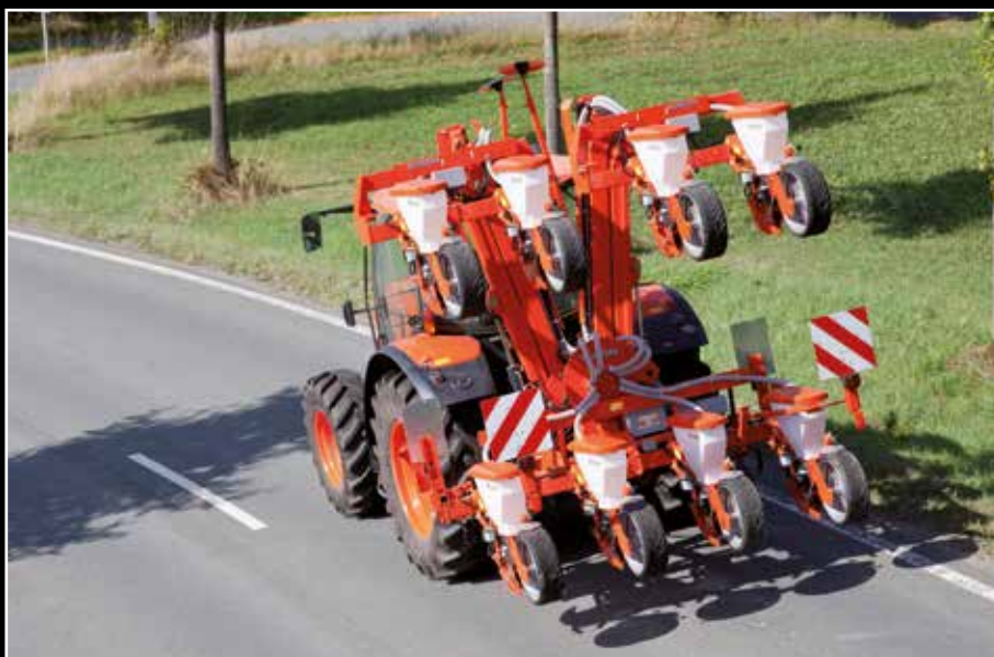
Châssis 6.00m repliable au transport (<3m)
