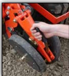
3 réglages différents pour le recouvrement: Pression, largeur et angle des roues
