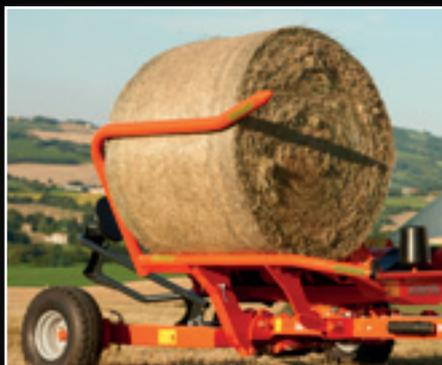
*La horca de carga con accionamiento hidráulico y baja altura lleva la paca rápidamente a la mesa.*
