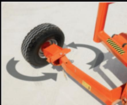
*Para estrechar el ancho de trabajo se puede voltear la rueda del costado derecho.*
