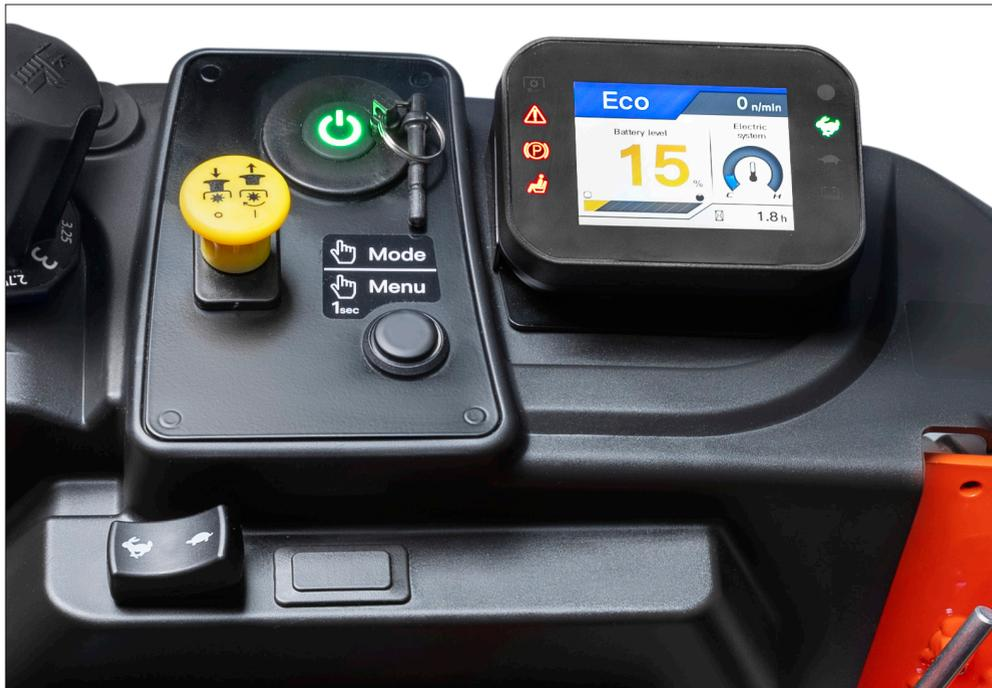
All'interno della console di destra si trova il pannello dei contatori. Questo pannello consente di conoscere lo stato attuale della batteria per quanto riguarda i livelli di carica. Il pannello è inoltre dotato di un display diagnostico dei codici di errore che consente di riconoscere rapidamente e facilmente eventuali guasti.
