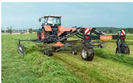
L'effet Touch-Down, comparable à l'angle d'approche d'un avion sur son châssis d'atterrissage, assure un andainage propre et en douceur, mais évite également, en soulevant jusqu'à une garde au sol d'environ 500 mm, d'endommager les andains en fourrière.
