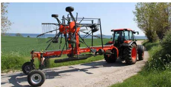
Pour limiter la hauteur de transport, les dents peuvent être démontées. La planche à andain se replie automatiquement.
