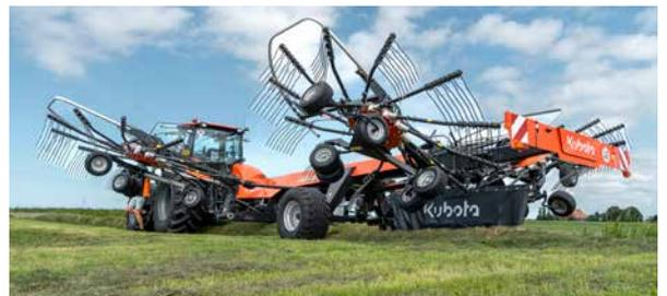
La hauteur de levage importante des rotors assure un dégagement généreux pour les manœuvres en fourrière.
