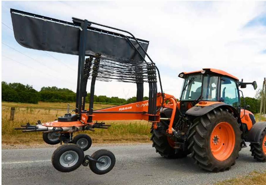
Pour le transport ou le remisage, les garants de protection latéraux se replient le long du châssis. Un ressort d'assistance monté sur la planche à andain permet de minimiser l'effort au repliage.
