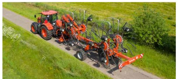
Son système de repliage permet de limiter la hauteur au transport à moins de 4 m, malgré des diamètres de rotors de 3,85 m. Et sans avoir à démonter les bras.
