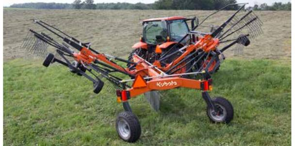
Pour limiter la hauteur de transport, les dents peuvent être démontées. La planche à andain se replie automatiquement.
