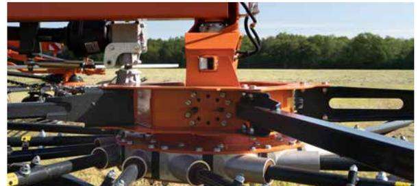
La hauteur de travail de chaque rotor peut être réglée indépendamment et hydrauliquement. De plus, une hauteur minimale peut être ajustée mécaniquement.
