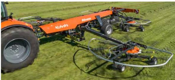
La largeur de travail réglable hydrauliquement de 10 à 12,50 m. La largeur des andains est également réglable de 1,20 à 1,90 m.
