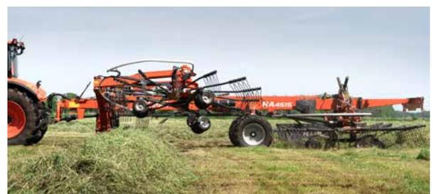
La hauteur de relevage importante des rotors assure un dégagement généreux pour les manœuvres en bout de champ.
