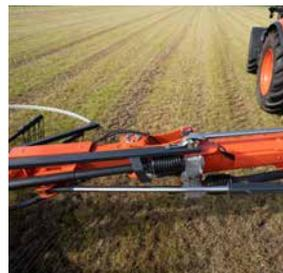
Suspension hydraulique et sécurité Non-Stop des bras de relevage avant.
