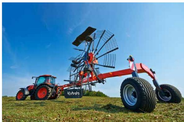
Equipé en standard d'un essieu auto-directionnel pour une manœuvrabilité exceptionnelle en combinaison avec des roues larges limitant le tassement.
