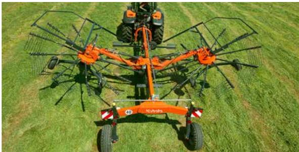
L'ajustement hydraulique des rotors permet un ajustement de la largeur de travail de 7 m...
