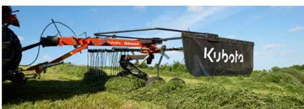
Les machines traînées peuvent être relevées facilement jusqu'à une hauteur de 50 cm depuis le poste de conduite.
