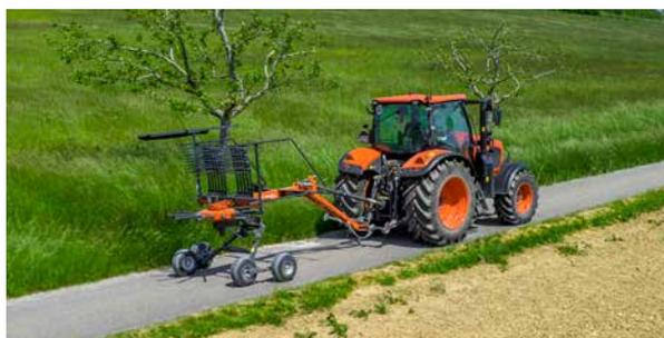
Sur tous nos modèles d'andaineurs, il est possible de réduire la largeur au transport en démontant les bras et en les insérant sur les supports fixés au châssis.
