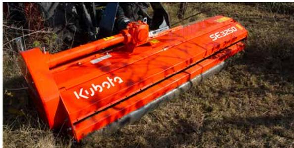
Un rouleau de 160 mm de diamètre avec racleur réglable est monté de série et assure un parfait suivi du terrain.
