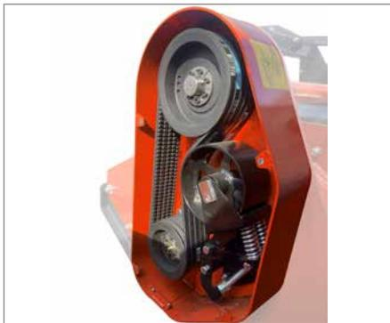
Le tendeur de courroie automatique assure une transmission stable du rotor dans toutes les conditions de travail.
