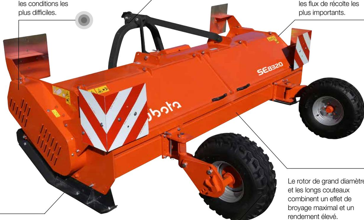
Plaque d'usure boulonnée sur les patins, facilement interchangeable.
