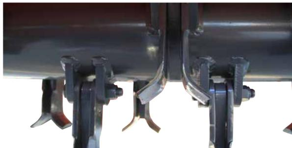
Le rotor du SE7280L peut être équipé de lames Y ou de marteaux. Les patins latéraux sont montés de série.
