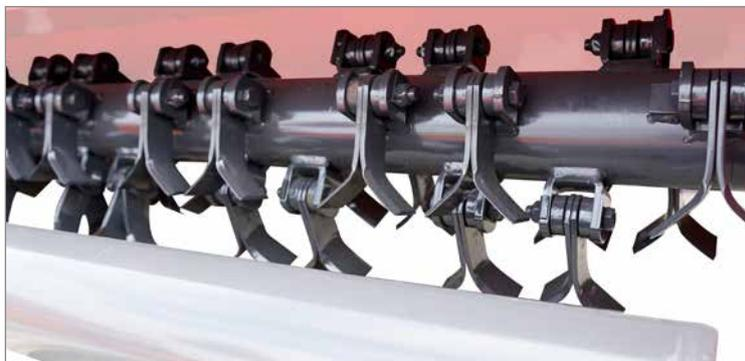
La vitesse élevée du rotor et les lames Y offrent les meilleurs résultats pour l'entretien des espaces verts. Le rotor est équilibré pour un niveau de bruit et de vibration réduit.
