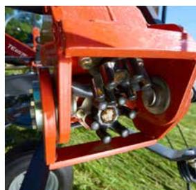
L'entraînement à doigts HexaLink Kubota permet de replier les rotors à 180° pour le transport.
