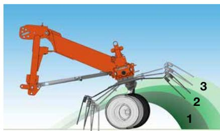
Réglage à 3 positions de l'angle de travail des rotors afin de s'adapter à tous les types de fourrage.
