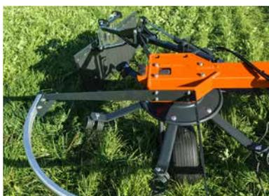
Une planche à andain hydraulique permet de maintenir la récolte dans la largeur de travail de la machine (option).
