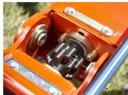
L'entraînement HexaLink permet un repliement à 180° des rotors extérieurs au transport.
