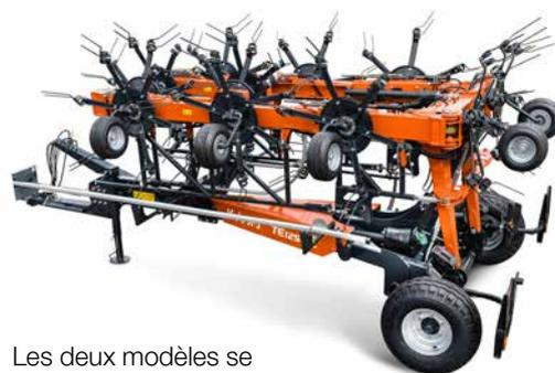
Les deux modèles se replient sur une largeur de transport inférieure à 3 m et se conduisent comme une remorque sur la route, en suivant le tracteur en douceur.
