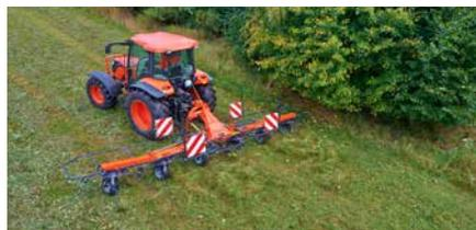
Mise en oblique centralisée en standard sur tous les modèles.
