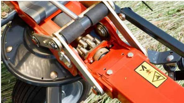
Entraînement à doigts HexaLink permettant un repliement au transport à 180°.
