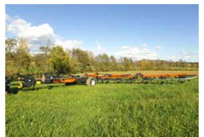
Les 2 modèles se déplient facilement en trois étapes. Tout d'abord, elle est soulevée avec un simple effet hors des supports de transport. Ensuite, elle est dépliée en position fourrière via le double effet. Enfin, elle est abaissée en plaçant le simple effet en position de flottement.
