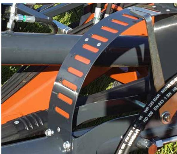
Le réglage hydraulique de la hauteur est disponible en option et contrôlé par un double effet supplémentaire. Un repère visuel est facilement lisible depuis la cabine, ce qui facilite le réglage de la machine.
