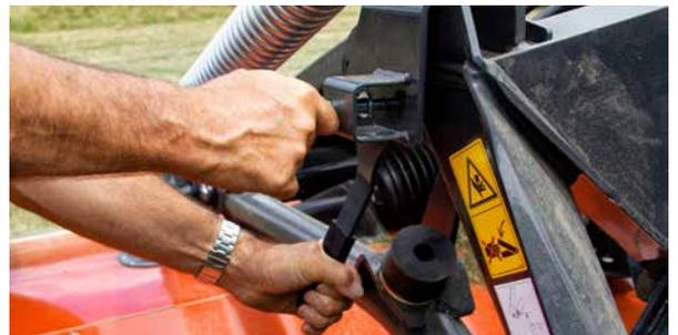
Une seule poignée de stationnement pour verrouiller et préparer la machine au démontage.
