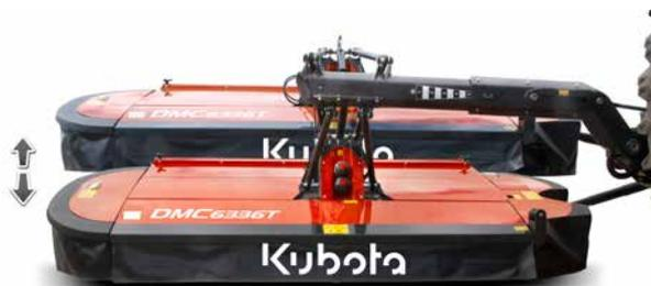
Système de suivi du sol exceptionnel. Les quatre bras de suspension se relèvent de 400 mm et se baissent de 300 mm pour un suivi précis.
