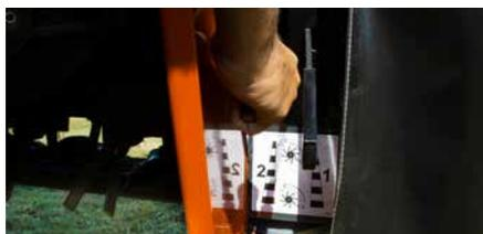
Double réglage de la tôle de conditionnement.
