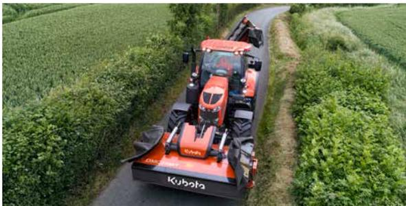
Repliage hydraulique des protections FlexProtect (en option).
