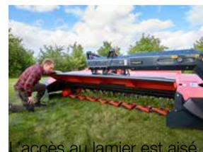
L'accès au lamier est aisé et rapide, facilitant l'inspection quotidienne des disques et des couteaux.
