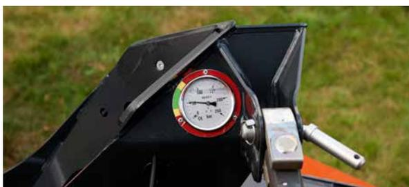
La pression au sol se règle facilement depuis le siège du tracteur, grâce à un dispositif hydraulique qui inclut une échelle graduée facile à lire sur la faucheuse pour une vraie aide à la conduite.
