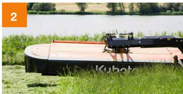
Le bras de support revient en place pour amener l'unité de fauche en position stable avant d'être abaissée.
