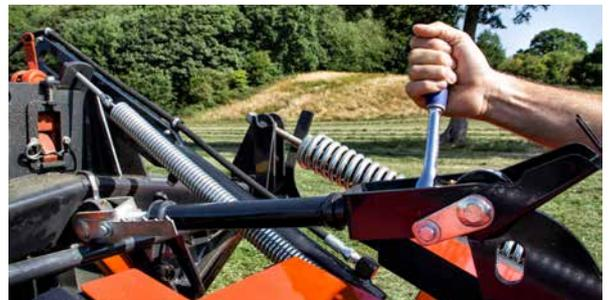
Le réglage de la hauteur de fauche est intégré directement dans le relevage de la machine. Il n'est pas nécessaire d'incliner la tête d'attelage.
