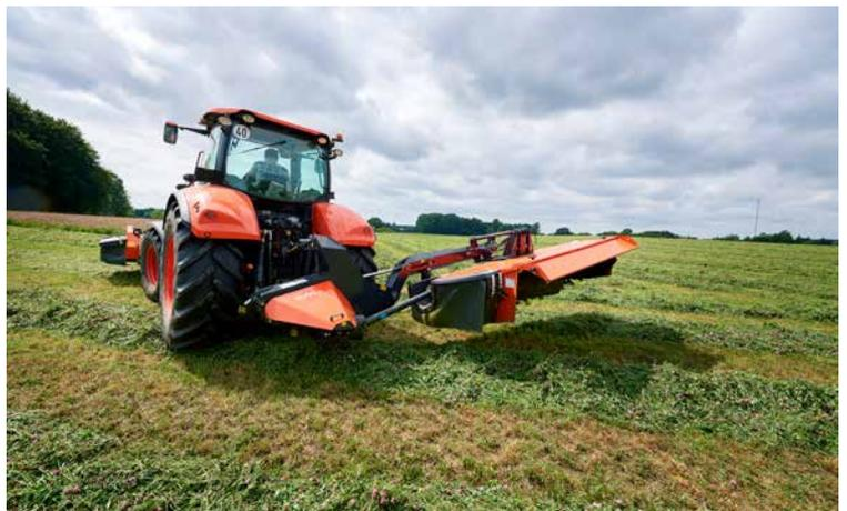
Distance minimale de 500 mm par rapport au sol, des unités de fauche lors des manœuvres en fourrière. L'unité de fauche est levée et le bras porteur incliné de 10°.
