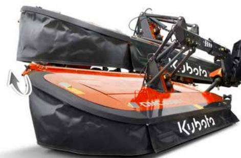
Sécurité Non-Stop – En cas d'obstacle, l'unité de fauche recule puis se relève, même sur le côté intérieur de la faucheuse, puis revient en position de travail une fois l'obstacle passé. Aucun arrêt nécessaire – aucune perte de temps.
