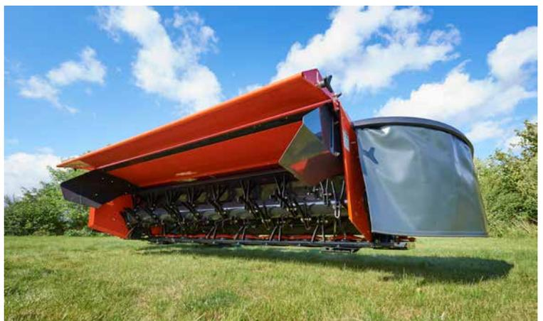
Le passage de l'andainage à l'épandage large s'effectue en une minute montre en main. Les volets d'andainage s'escamotent facilement sur le côté, le système d'épandage large FlipOver se tourne de 180°. Aucun outil n'est nécessaire.
