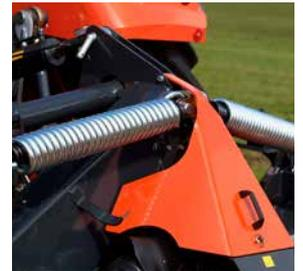
Ressorts de suspension de large section, réglables hydrauliquement, en option.
