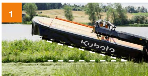
Garde au sol de 500 mm sur l'ensemble de l'unité de fauche lors des manœuvres en fourrière. L'unité de fauche s'élève et le bras de support s'incline à un angle de 10°.
