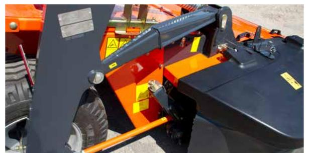
En cas d'obstacle, la faucheuse recule tout en montant pour esquiver l'obstacle et revient automatiquement en position de travail une fois celui-ci passé.
