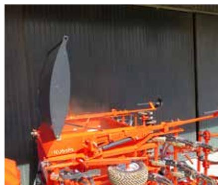
Une plateforme d'accès avec rambarde sécurise l'accès à la trémie. Elle peut facilement être remplie par des big-bags avec un chargeur de tracteur, un télescopique, ou un transbordeur, sans avoir besoin de déplier le semoir.
