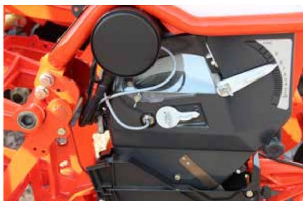
Chaque rang équipé d'un entraînement électrique e-drive II est capable d'exécuter les fonctions GEOCONTROL et GEOSEED.
