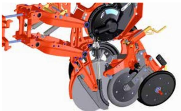
Placement précis de la semence par le soc qui forme un sillon propre. La position et le recouvrement de la graine sont assurés par la roue intermédiaire et les différents réglages des roues arrière plombeuses en V y contribuent également.
