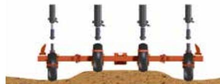
Adaptation individuelle et intelligente des roues pour un suivi du sol optimal grâce aux vérins à double tiges.
