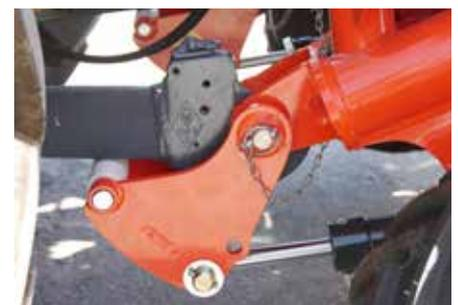
Kit de lestage hydraulique de châssis
