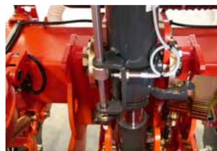
Un vérin intelligent en deux parties : suivi de terrain et levage de la machine
