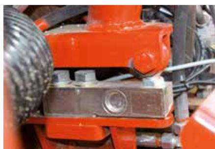
Pesons pour contrôle et application de l'engrais
