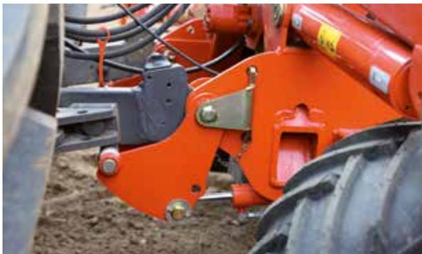
Kit de lestage hydraulique de châssis
