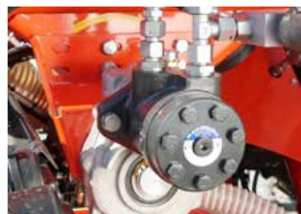
En option, l'entraînement hydraulique du fertiliseur. La dose peut être modulée en cours de travail.
