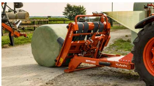
Capable de recevoir des balles rondes jusqu'à 1200 kg.
