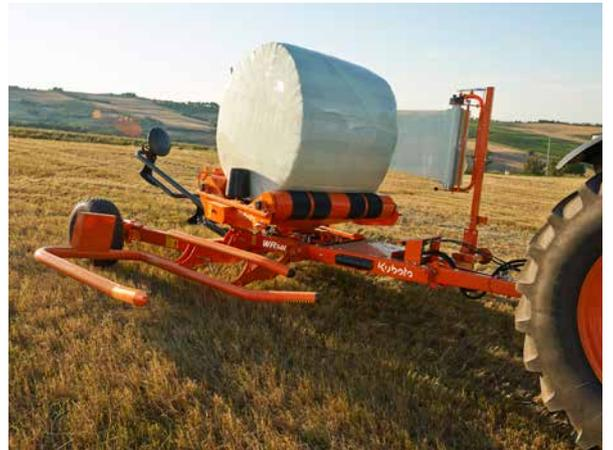
Table tournante avec deux rouleaux entraînés, conçue pour une grande stabilité des balles et une rotation régulière.
