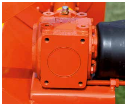
Alle Kubota Mulcher besitzen serienmäßig einen Freilauf im Getriebe.
