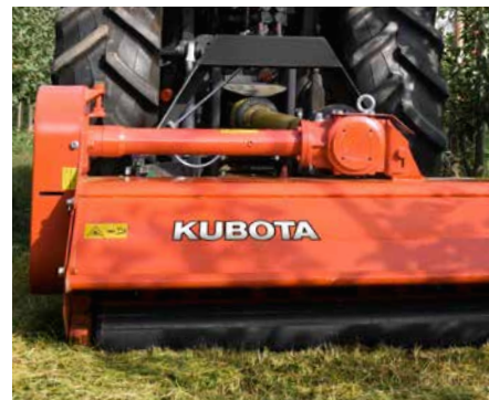
Die Stützwalze ist für eine optimale Schnitthöhe höhenverstellbar.
