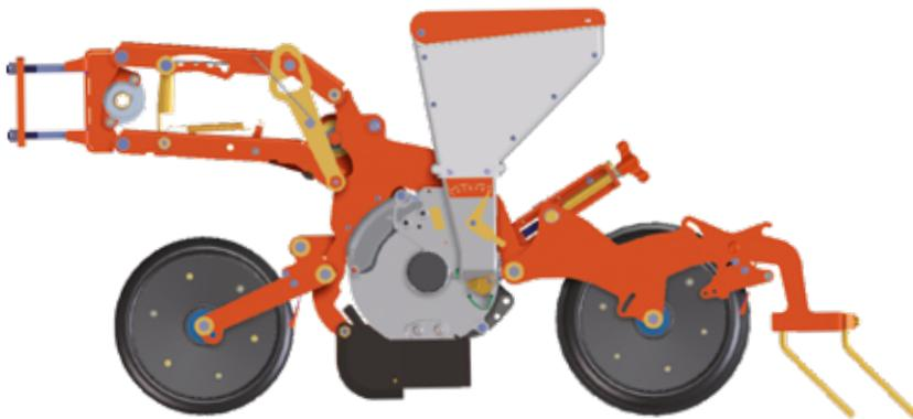
Durch die abhängig voneinander aufgehängten vor- und nachlaufenden Druckrollen wird eine gleichmäßige Tiefenführung des Säschars erzielt. Die Sätiefe wird einfach und bequem über eine Spindel am Tandemwagen eingestellt. Ist die erste Reihe eingestellt, kann der Skalenwert auf alle anderen Reihen übertragen werden. Die einzelnen Säereihen sind mit einer Rahmenklau am Grundrahmen befestigt. Dies ermöglicht eine einfache und individuelle Anpassung des Reihenabstands.
