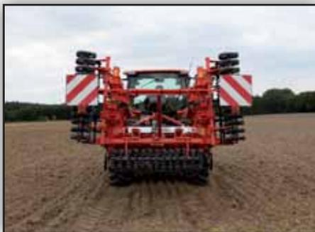
Sicherer Straßentransport (2,50 m) und einfache hydraulische Umstellung von Transport in Arbeitsposition. Alle TH-Modelle sind zur besseren Anpassung an die Bodenkontur in drei Segmente aufgeteilt.
