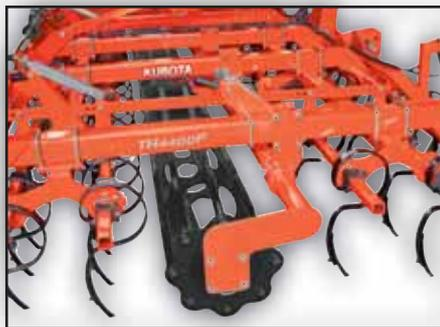
Das flexible Anbauprinzip durch Bolzen ermöglicht je nach Anforderung ein Versetzen der Rohrstabwalze von vorne zwischen die einzelnen Zinkensegmente. Empfohlen bei trockenen Bedingungen.
