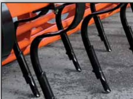
Die geraden Zinken erlauben ein sorgfältiges Einebnen sowie eine gute Krümelung der Oberfläche zur Saatbettbereitung. Für Böden mit einem hohen Steinbesatz kann die TH1000 mit zwei Reihen Schleppzinken ausgerüstet werden.
