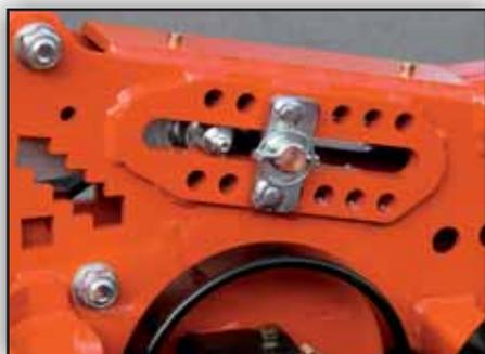
Die verschiedenen Nachläuferwalzen garantieren eine gute Tiefenführung und Rückverfestigung auf unterschiedlichsten Böden. Die Tiefenführung wird je nach Säeschiene über ein Lochbild oder ein Parallelogramm festgelegt.
