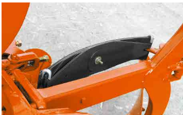
Resor HD z 9 piórami (900 kg)
