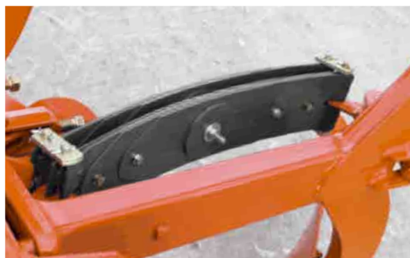
Podwójny resor z 14 piórami (1400 kg)
