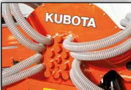
Zentrales Gebläse für konstanten Vakuumdruck aller Säreihen
