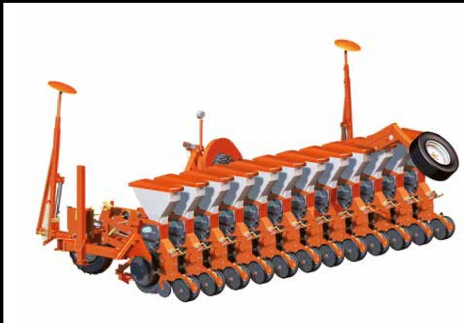
PP1600 mit 12 Reihen in 6,10 m Arbeitsbreite und Langfahrvorrichtung
