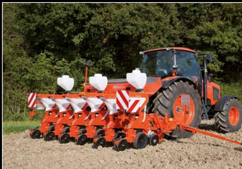
PP1450V e-drive II: 6 Reihen variabel teleskopierbar, 4,5 m Arbeitsbreite, 1000l Düngerkapazität
