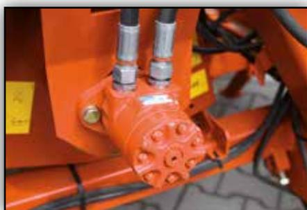
Optional hydraulischer Gebläseantrieb
