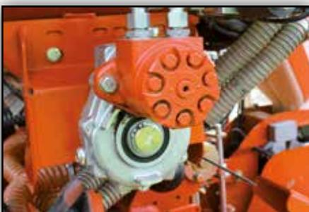
Elektrohydraulischer Antrieb zur Düngerausbringung
