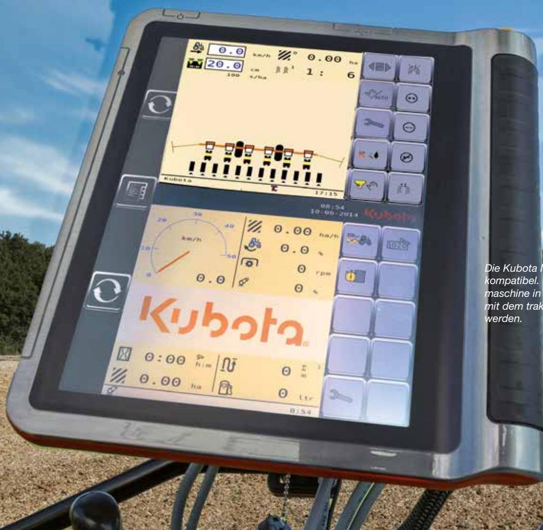
Die Kubota M7001 Serie ist ISOBUS 11783 kompatibel. Somit kann die Einzelkornsämaschine in der ISOBUS Ausführung direkt mit dem traktoreigenen K-Monitor bedient werden.
