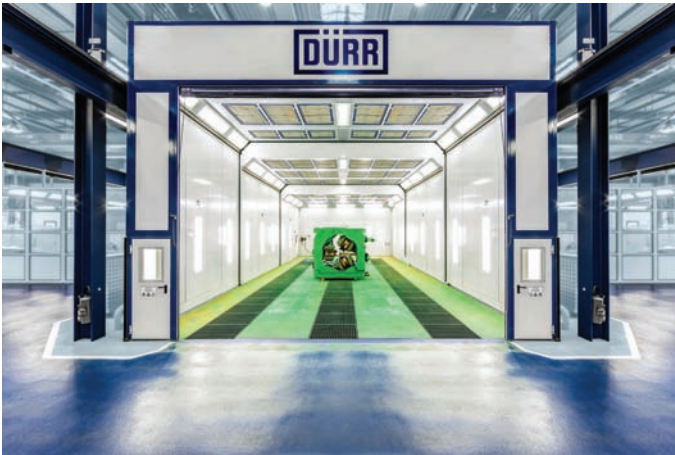
Büyük makine parçaları teleskopik kabinde çevreye uygun ve verimli şekilde boyanmaktadır.
