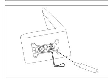
STEP 4: INSERT THE GAS LEVER TO BASE PLATE. MAKE SURE THEY ARE IN CORRECT POSITION.
