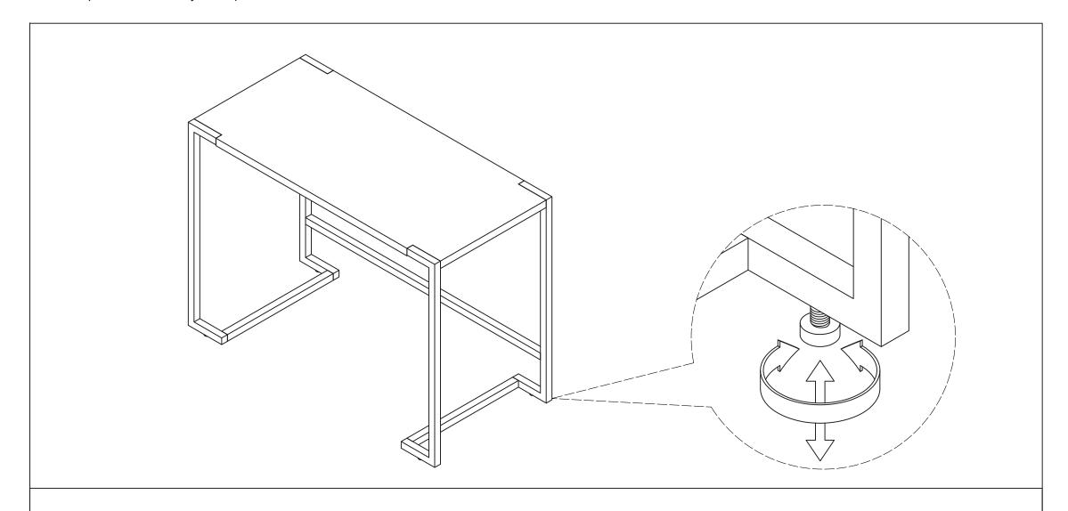
STEP 5 ADJUST THE ADJUSTER THAT HAS ALREADY BEEN ASSEMBLED TO THE LEGS TO STABILIZE YOUR UNIT.
