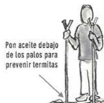
2. Coloca los palos de forma "Y" en los huecos y asegura que estén nivelados
