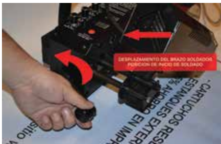
Fig.07 Manilla a posición de soldadura
