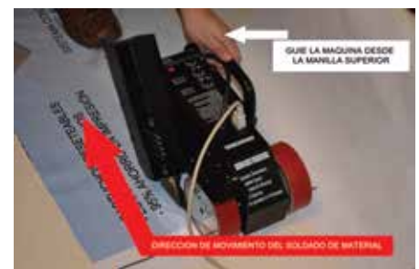
Fig.08 Dirección de desplazamiento y manilla guía.
