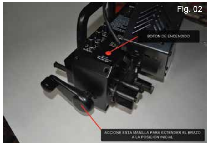
Fig. 02 - Manilla para extender el brazo y Boton de encendido
