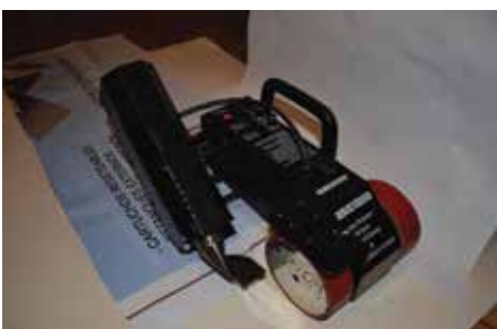
Fig. 03 - Posición inicial para soldar, al borde del material
