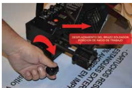
Fig. 04 - Manilla del brazo soldador a posición de Inicio
