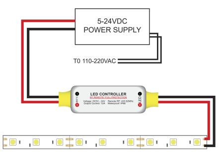
5VDC: 60W Max 12VDC: 144W Max 24VDC: 288W Max
