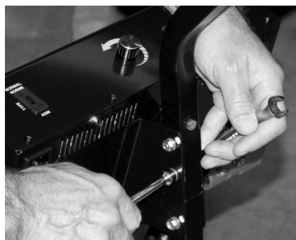
Montaje del gabinete de control
