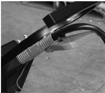
Conexión rápida de carga (rojo) con conexión rápida de selección de tensión agregada
