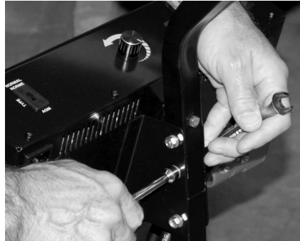
Montage du boîtier de distribution
