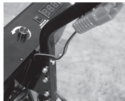
Les câbles de charge doivent passer dans les oreilles de fixation du boîtier de distribution.
