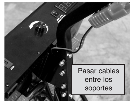
Cables protegidos de conexión rápida de carga
