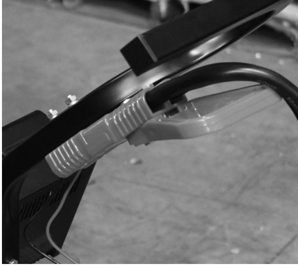
Connexion rapide de charge (rouge) avec connexion rapide de sélection de tension attachée
