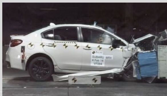
Frontal offset test at 64km/h (Subaru WRX)
