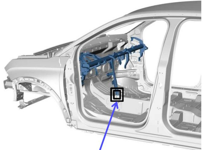
2/ Abstützung: unter der Mittelkonsole; diese Stütze muss zum Wegklappen des Frontmoduls durchtrennt werden.
