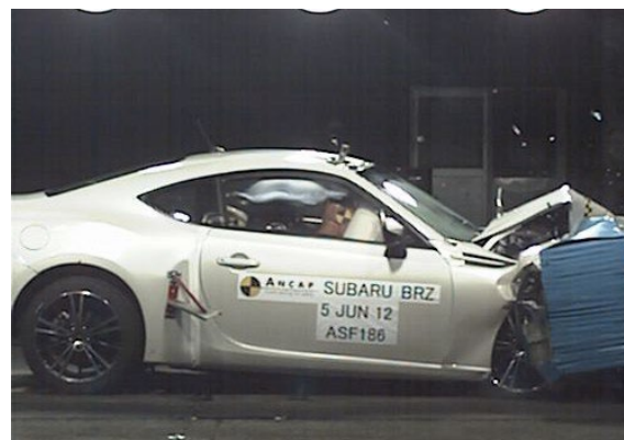
Frontal offset test at 64 km/h (Subaru BRZ)
