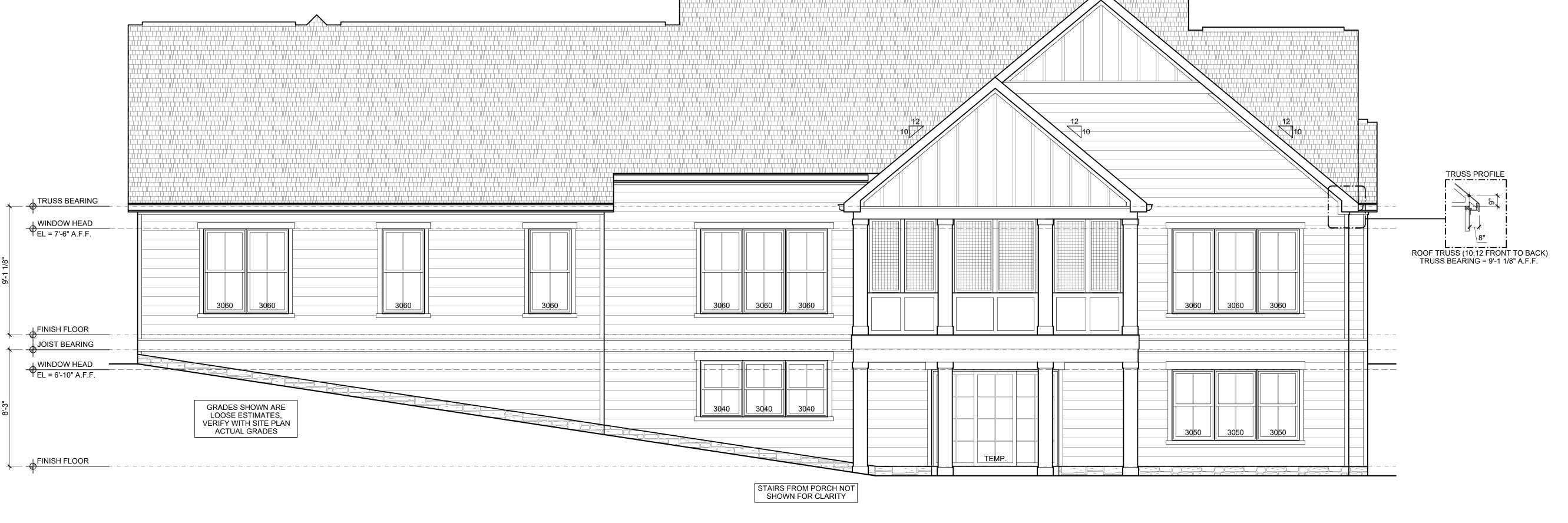
REAR ELEVATION ROOF TRUSS (12:12 SIDE TO SIDE)
