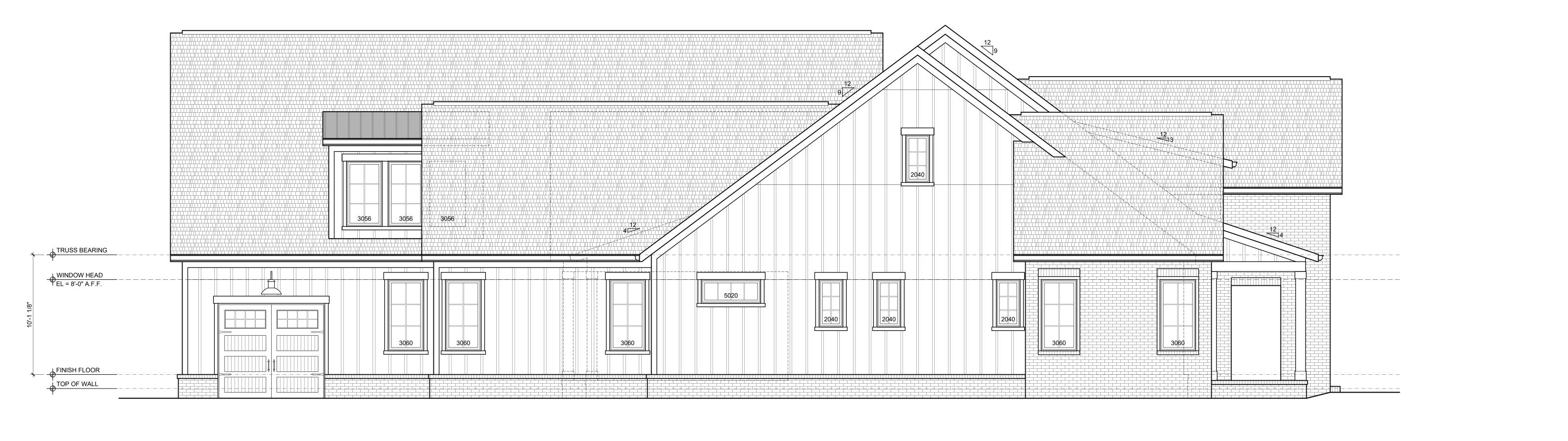
ELEVATION MATERIAL LEGEND — STANDING SEAM METAL ROOF -BOARD & BATTEN SIDING BRICK VENEER
