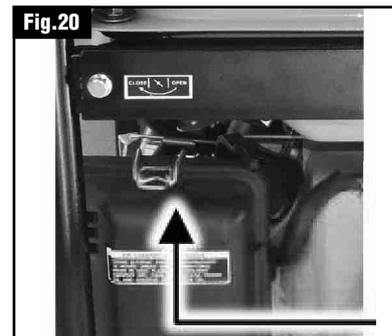
6. Gire el INTERRUPTOR AUTOMÁTICO a la posición ON (Encendido).
