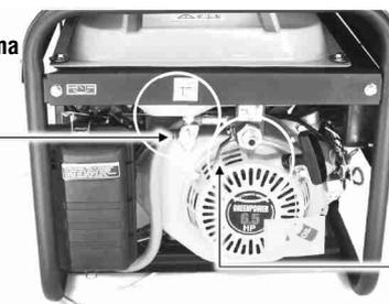
Interruptor de Encendido/Apagado
