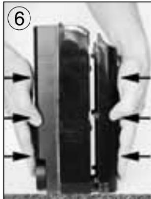
Nach Beendigung der Wartung, die verschiedenen Komponenten rückwärtig wieder zusammensetzen. Gehäuse und Blende auf eine gerade Fläche stellen (6) und zusammenschieben. Der Silikonschlauch darf nicht geknickt sein!
