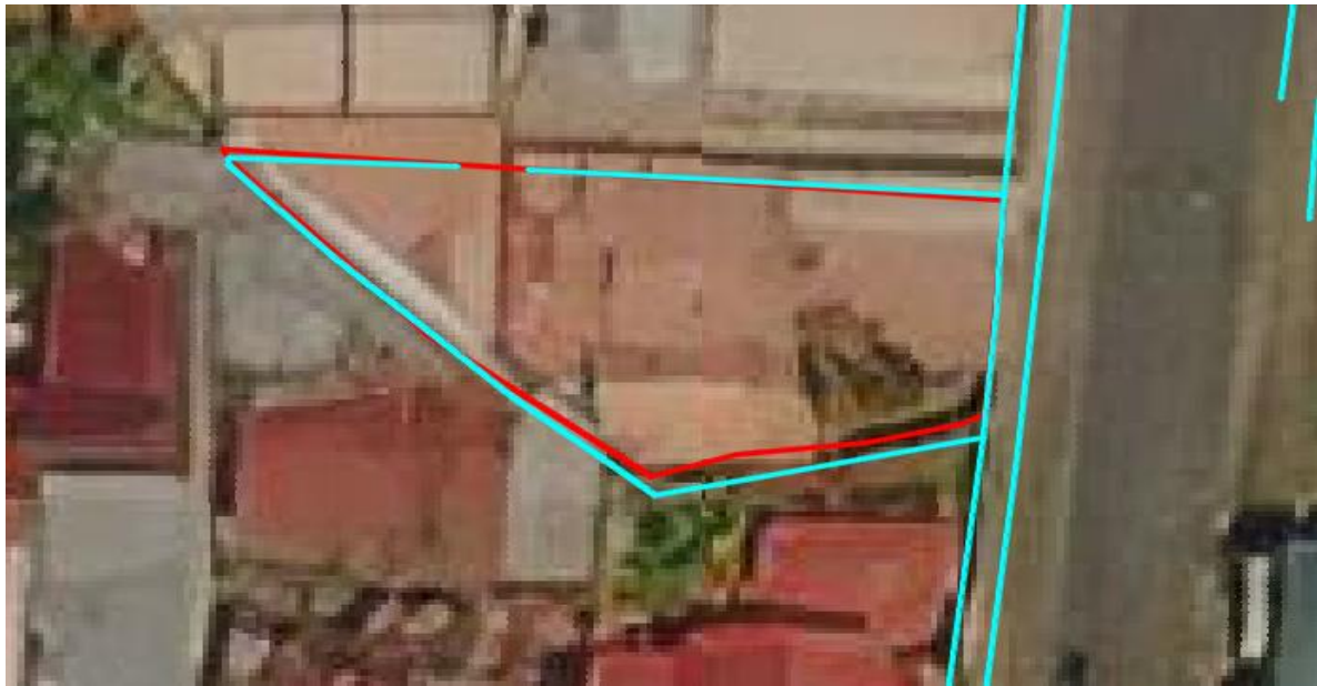
Fotografía tomada del levantamiento topográfico, donde la diferencia se observa entre el plano catastrado (polígono rojo) y el levantamiento topográfico (polígono celeste)
