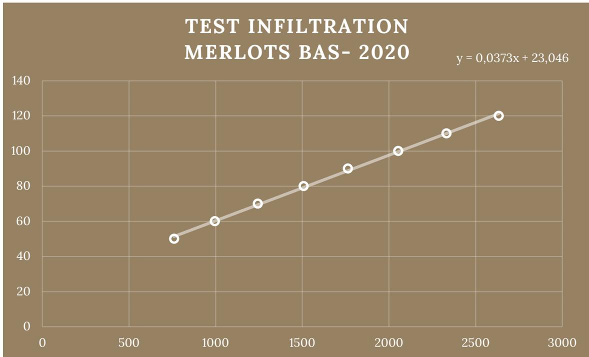
Perméabilité de 0.0373 mm/s soit 13 cm/h = Perméabilité élevée
