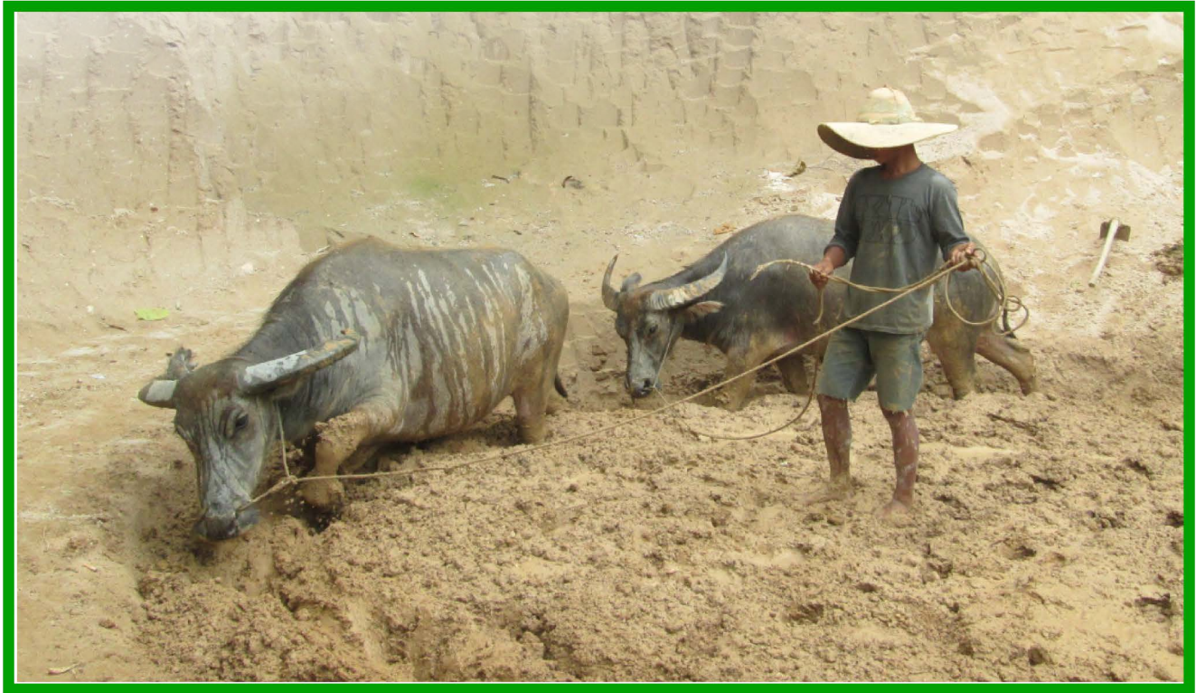
Cara mencampur secara manual dengan tenaga kerbau (merancah)
