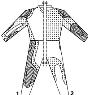
Les tests mécaniques sont effectués sur quatre types de zones différentes. Veuillez-vous référer au schéma des zones testées ci-dessous.
